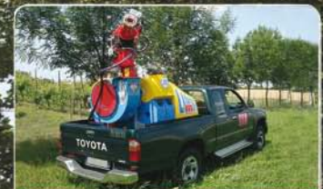
Nebulizzatori a cannone (13 a 140 CV) con ULV, Termonebbiogeno e carica Elettrostatica delle goccioline integrati
